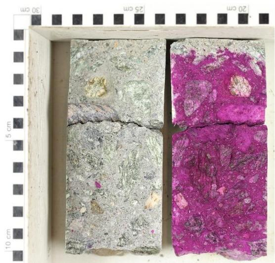
Abbildung 7: Bohrkernentnahme am Objekt und Bestimmung der Karbonatisierungstiefe am Bohrkern
