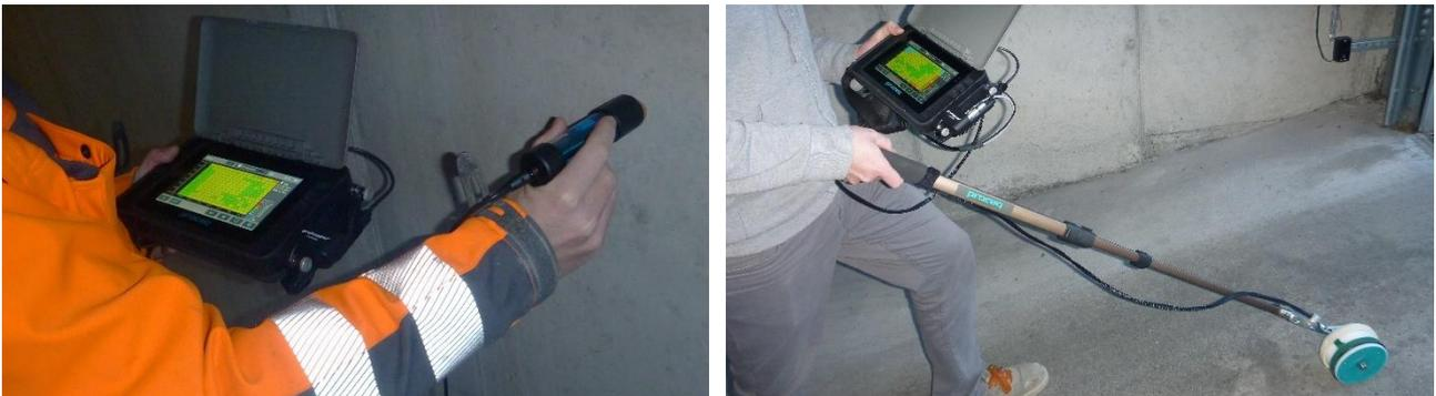
Abbildung 4: Potentialfeldmessung (links: Stab-Sonde; rechts: Einrad-Sonde)
