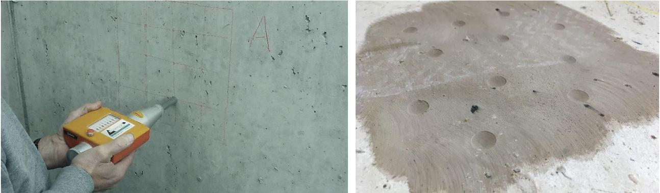
Abbildung 3: Prallhammer-Messung (links: Messung; rechts: Einschlaglöchern einer weichen Oberfläche)
