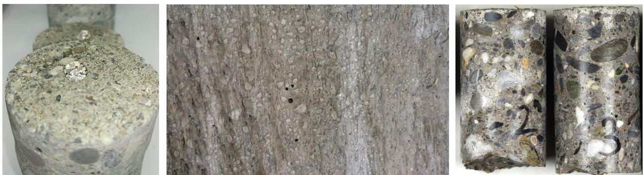
Abbildung 10: Hydrophobierung (links/Mitte: Abperlen; rechts: Prüfung Wasseraufnahmekoeffizient)
