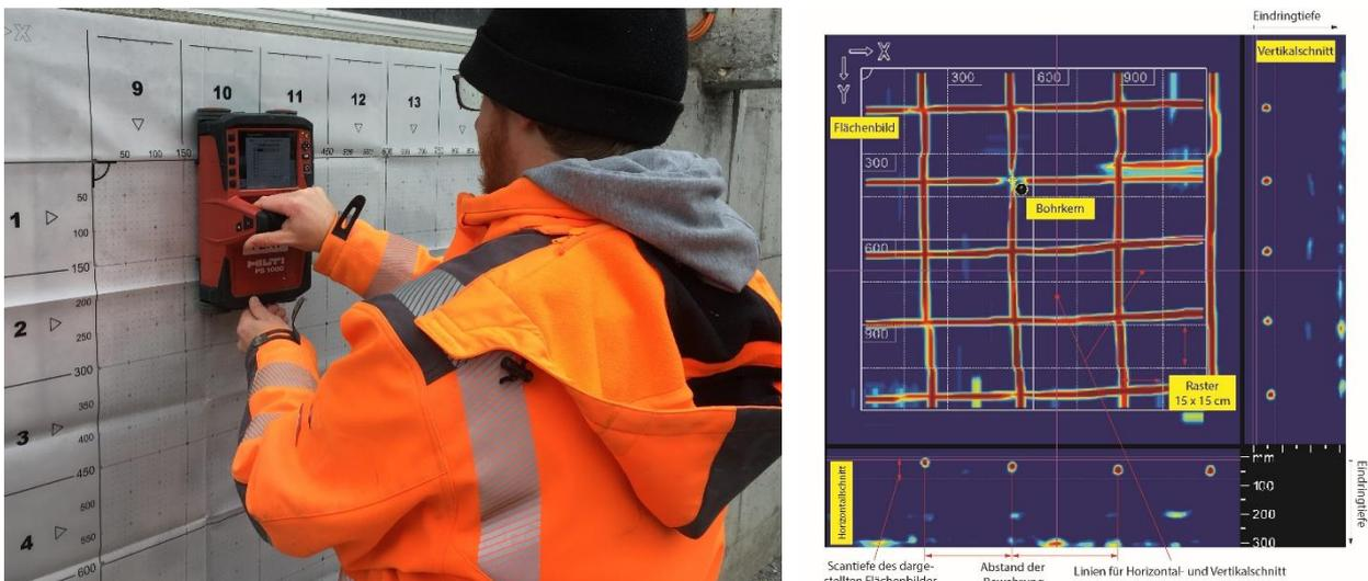
Abbildung 2: Aufnahme und Darstellung eines Flächenscans
